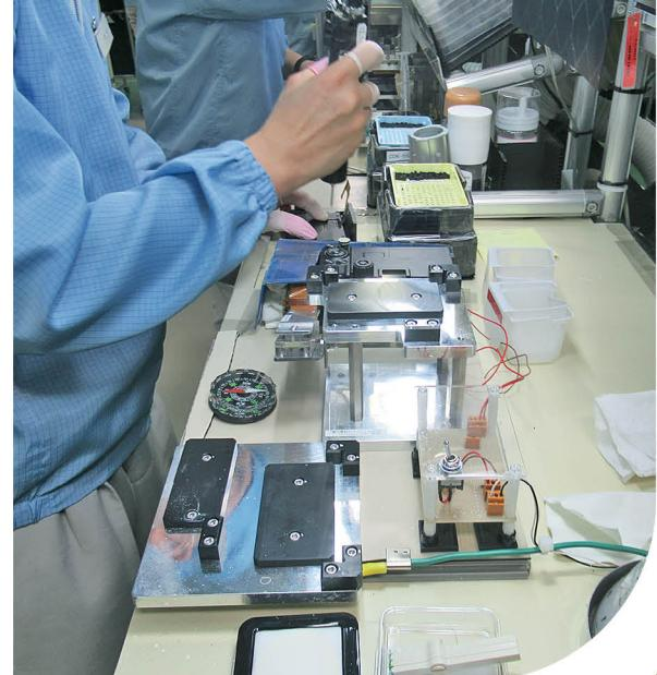
2022年からポートフォリオの大転換を図り、キヤノンの『誇り』とも言えるデジタルカメラのキーとなるユニットの生産を開始。キヤノンプレシジョンのお家芸とも言えるセル生産へ、局所クリーンブースを導入し、カメラ製品の大敵であるゴミケバを徹底排除。さらなるモノ作りへの進化と、終わりない改善力で高品質、低コストを実現します。
